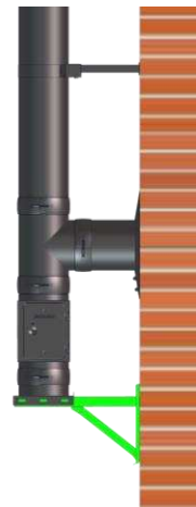
Bild 5-4: Aufbau Grundplatte mit Kondensatablauf und Wandstütze „schenkelabwärts“
