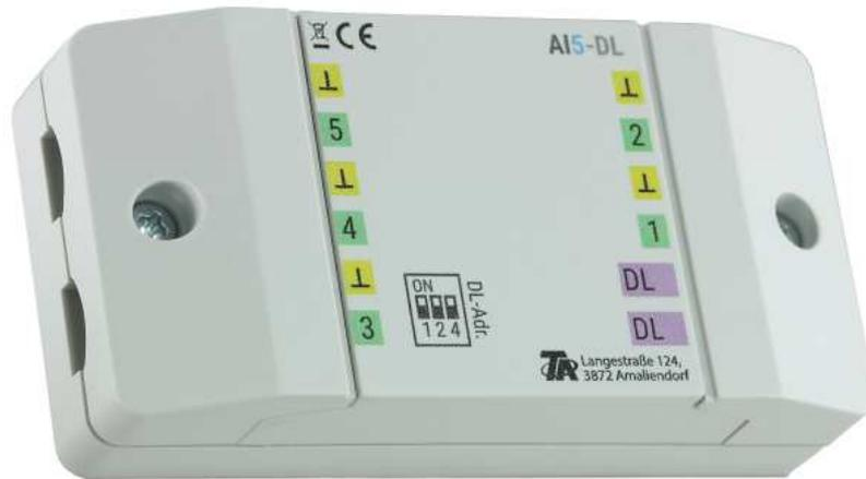
Der AI5-DL (= „Analogue Input“) übersetzt Signale für die Datenleitung (DL-Bus). Diese können von bis zu 5 verschiedenen externen 0-10V Quellen stammen. Es wird empfohlen, die auszulesenden 0-10V-Sensoren und den AI5-DL vom gleichen Regelgerät mit Spannung zu versorgen.
